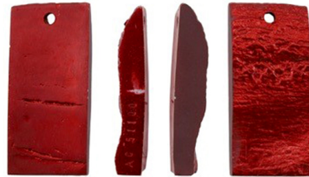
Fig. 9. Anodizado y coloreado, en rojo fuego, de una probeta de la aleación AW-51100.
