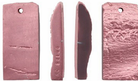
Fig. 5. Anodizado y coloreado, en rosa burdeos, de una probeta de la aleación AW-51100.
